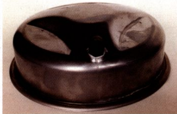
Bild 3: Der pneumatische Stellantrieb der Serie 2 Typ KP wurde einem aufwändigen Salz-Sprühtest nach ASTM mit einer Dauer von 96 Stunden unterzogen.
