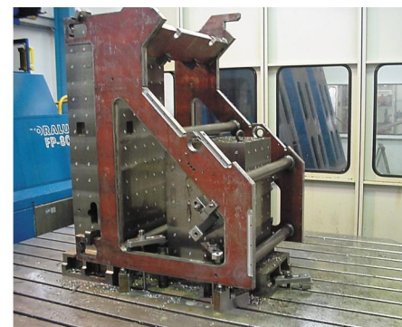
Fertigung eines Maschinengestells für eine Wertpapiermaschine. (Quelle: WINKLER + DÜNNEBIER, Neuwied)
