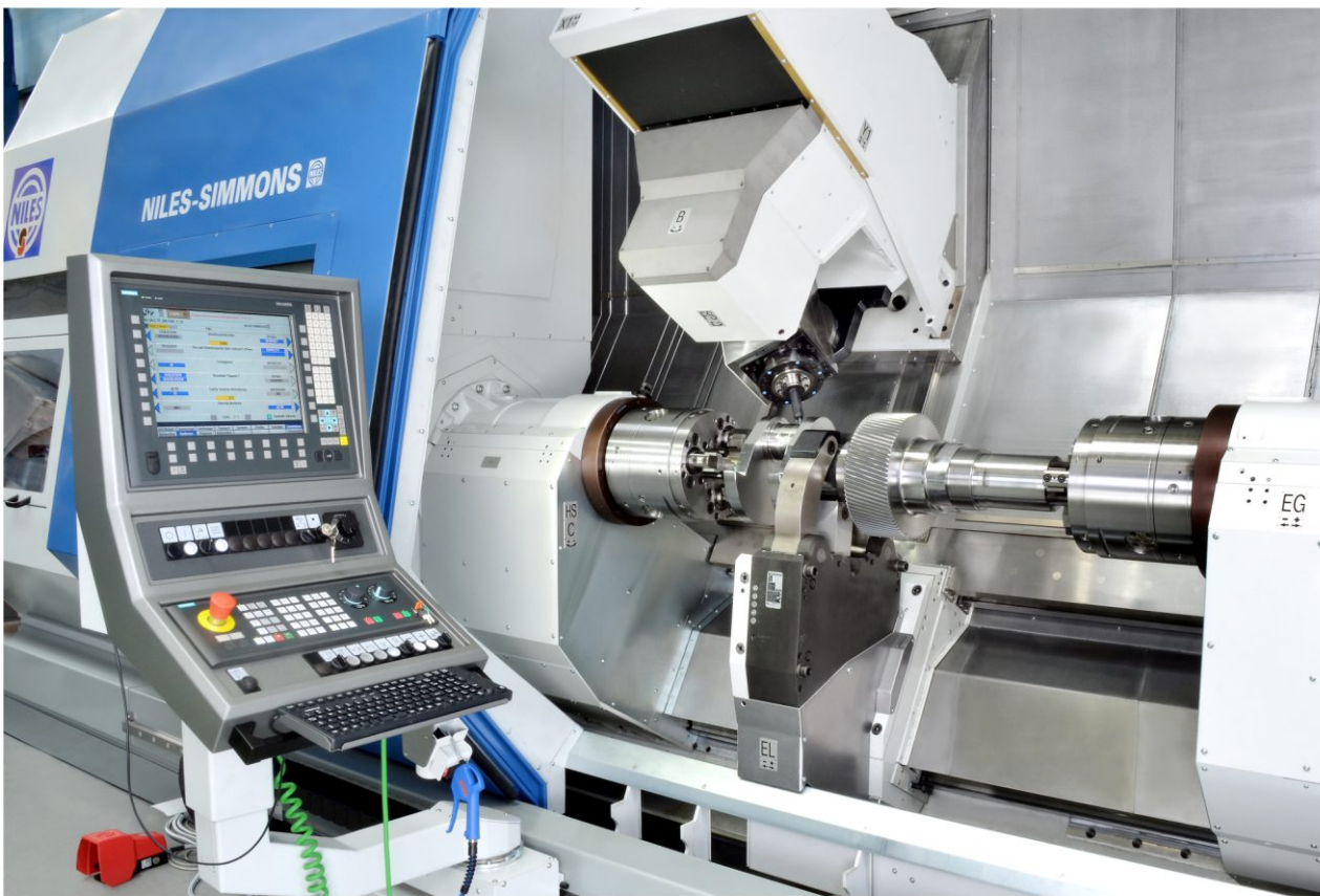
Arbeitsraum des CNC-Bearbeitungszentrums N30 MC von Niles-Simmons (Quelle: NILES-SIMMONS Industrieanlagen)
