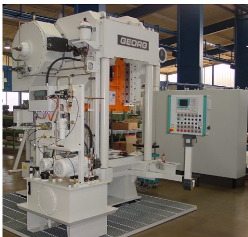
Dieser Stanzautomat PED 100 SD mit 1.000 kN Einständer-Exzenterpresse, Stanz- sowie Nachschneidewerkzeug dient mit zur vollautomatischen Fertigung von Kugelkäfigen mit sechs Fenstern für die Antriebswellen in PKW's. (Quelle: Georg Maschinentechnik, Neitersen)
