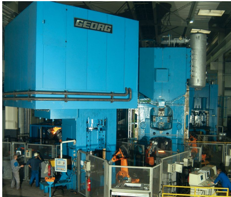
Abgebildete Presse wird unter Verwendung entsprechender Werkzeuge ausgelegt zum Vorstauchen. Sie verfügt über eine Stoßelndruckkraft von 16.000 kN und hat ein Gesamtgewicht von ca. 95.000 Kg. (Quelle: Georg Maschinentechnik GmbH & Co. KG, Neitersen)
