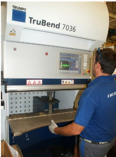
Filigrane Blechteile werden auf der sehr wirtschaftlichen elektrischen Abkantmaschine gekantet. (Foto: give4pr)
