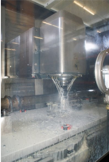
Mechanische Bearbeitung einer Schweißkonstruktion auf einer Fahrständerfräsmaschine (Foto: give4pr)
