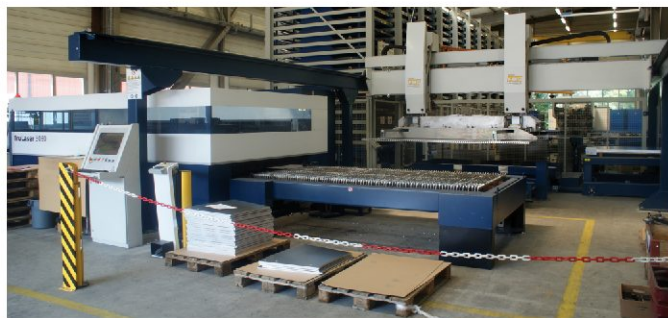
Vollautomatisierte Laserschneidanlage mit Hochregallageranbindung, automatischer Tafelbeladung, Teileabstapelung und Restgitterentsorgung (Foto: Give 4 PR)
