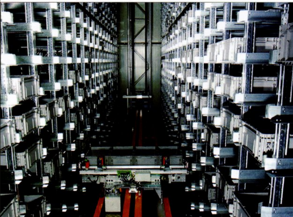
Blick in die Gasse des zehn Meter langen FCS mit vierfachtiefer Lagerung. (Fotos: KHT GmbH, Gelsenkirchen)
