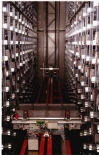
Blick in die Gasse eines 10 m langen FCS, das mit einem Standardteleskoptisch für vierfach tiefe Lagerung ausgerüstet ist (Foto: KHT)
