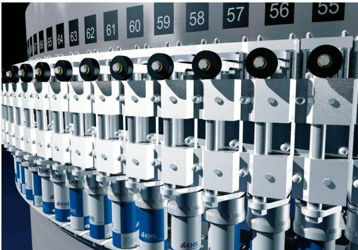
Rechnergesteuerter Dosenfüller Innofill DVD von KHS (Quelle: KHS AG)
