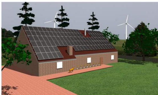
Modulbelegung unter Berücksichtigung der Verschattung – Fotorealistische Darstellung mit DDS-CAD PV (Quelle: SP Solar Power GmbH & Co. Managing KG)
