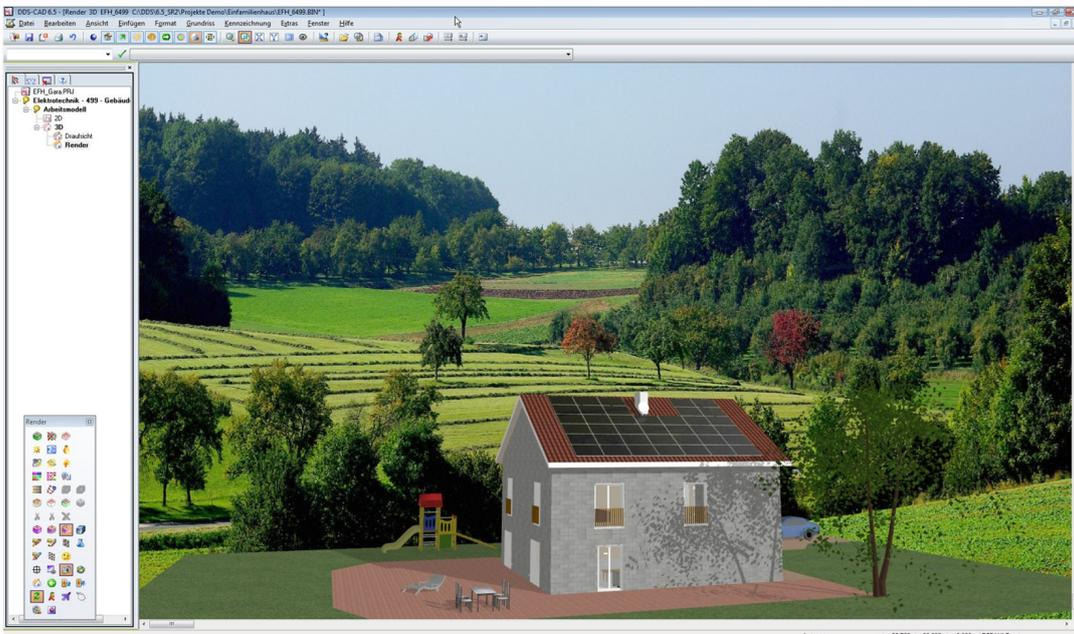
**DDS-CAD Polysun Inside erlaubt die fotorealistische Darstellung des Gebäudes inklusive Schattenwurf- und Sonnenverlaufssimulation.**
