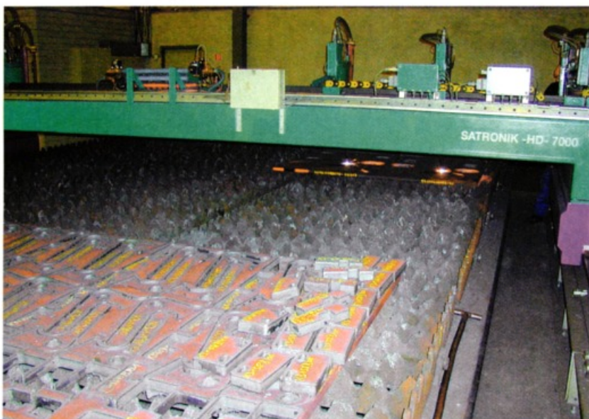
Zum autogenen Brennschneiden setzt Union-Stahl zwei CNC-Anlagen des Typs Satronik HD 7000 ein, deren Tische jeweils 6000 mm x 30 000 mm messen (Bilder: IBE)
