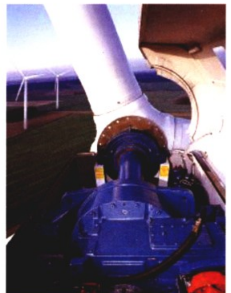
Flansch-Buchse wurde auf der neuen WFL M-100 mit Opus-NC-Programmen gefertigt
