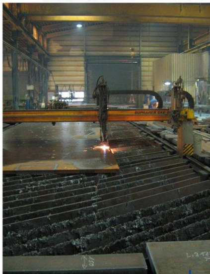
Bild 6. Brennschneiden mit einer Anlage vom Typ „Suprax“
