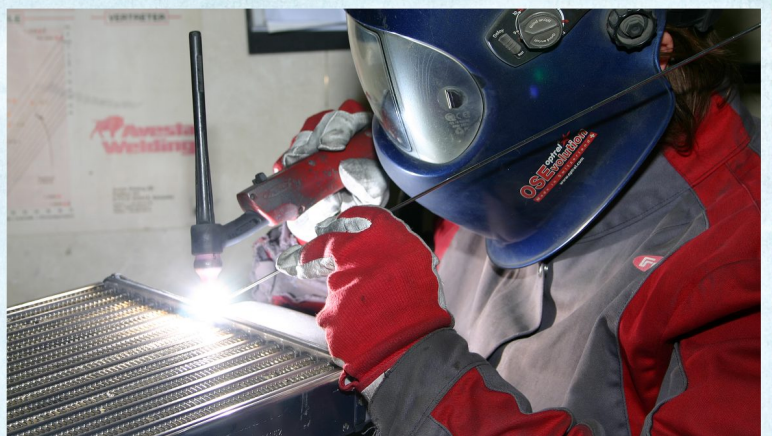
Schweißarbeiten am Aluminiumkühler für die Automobilindustrie
