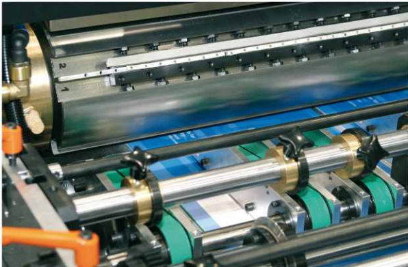
Ohne Zylinderwechsel kann die Querschneideeinheit unterschiedliche Papierformate schneiden. (Quelle: Jakob Graphic Services)
