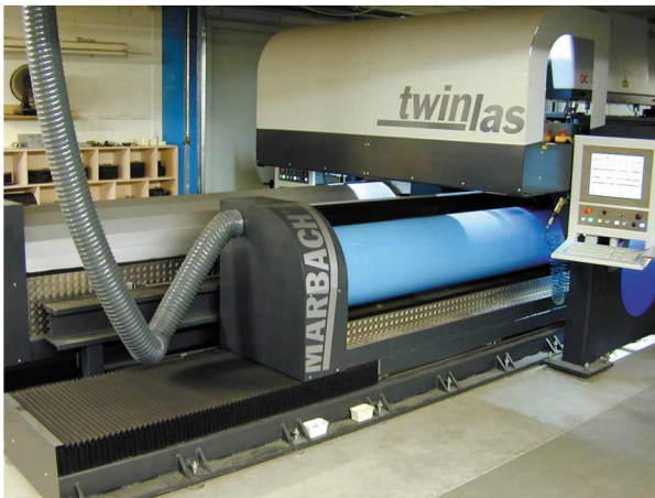
Das von Marbach entwickelte Rotationslasersystem 'twinlas' weist 11 Achsen, simultan agierend, auf. Zur Ausstattung und Ausgestaltung dieses neuen Prototypen haben u. a. die Komponenten Direktantrieb Cartridge DDR, wassergekühlter Linearmotor, Hochfrequenzumrichter, digitale Servoverstärker und kompakte Synchron-Servomotoren von Danaher Motion beigetragen. (Quelle: give4pr, Essen)
